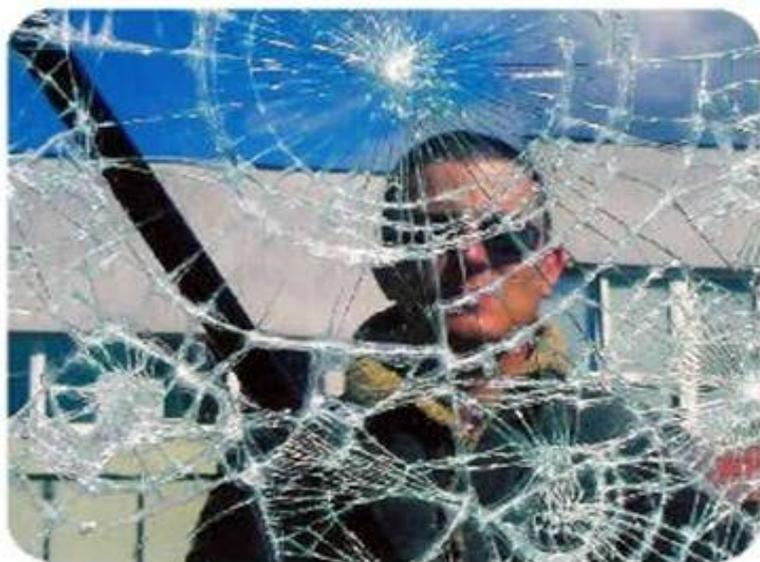
Для создания взрывоустойчивого остекления применяется специальный установочный раствор. Это связано с тем, что при взрыве на стекло воздействуют высокие динамические нагрузки и необходимо обеспечить баланс адгезии пленка-клей и клей-стекло.
