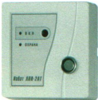
«Набат-ЛПП-2АК» - криптостойкое, автоматизированное, двухшлейфное устройство, управление через пароли доступа с помощью встроенной клавиатуры, возможность подключения токопотребляющих извещателей, питание от ретранслятора;
