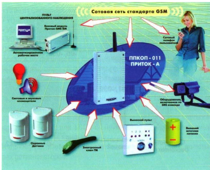
Подсистема «Приток-GSM» предназначена для организации централизованной или автономной (индивидуальной) охраны объектов, квартир, дач, гаражей и т. д., с передачей извещений по каналам сотовой связи стандарта GSM в режимах: SMS-сообщений, автодозвона или GPRS.
