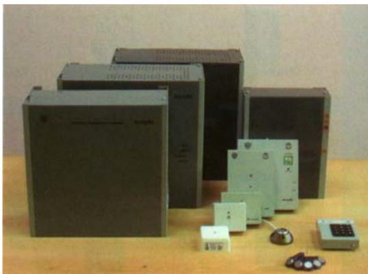
Объектовое оборудование включает в себя абонентский фильтр, УОО и приборы ППКОП. ФА предназначен для частотного разделения канала сигнализации и телефонного разговорного канала. УОО и ППКОП предназначены для контроля охранной, пожарной и тревожной сигнализации, считывания кода электронного ключа, контроля состояния основного и резервного питания и передачи информации на ПЦН.
