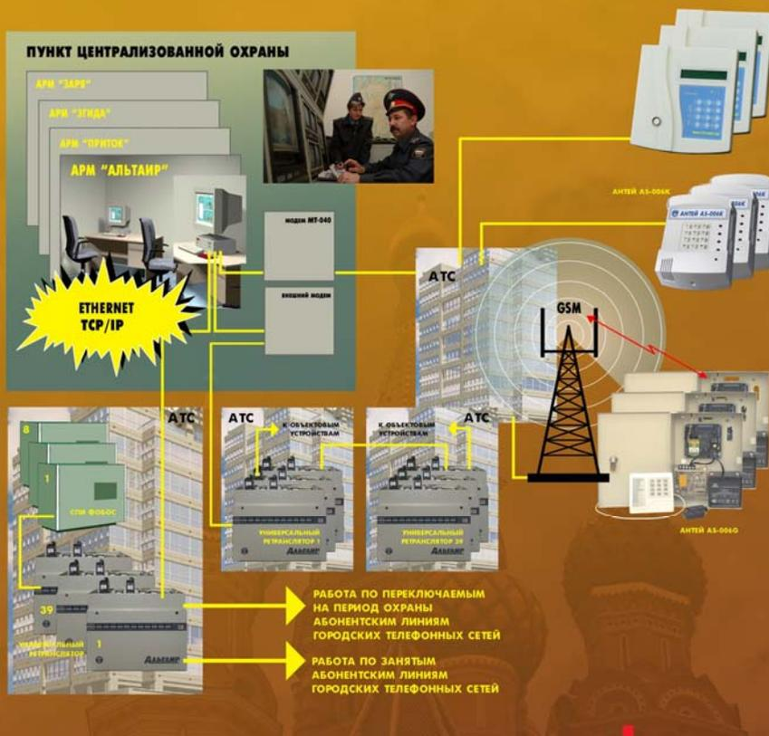
*Вариант структурного построения комплекса централизованного наблюдения охранно-пожарного КЦНОП049-2/2/240/7680-1 «Альтаир».*
