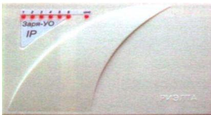
УОО «ГК-Заря-IP» (групповой концентратор) предназначено для приема и передачи сообщений об изменении состояния охраняемых шлейфов от приборов «Заря-ИО (индивидуальный ответчик)» и «Заря УСИ-2 (устройство сопряжения интерфейсов)» через корпоративную сеть TCP/IP, Интернет канал или GPRS модем на ПЦН и обратно. Обеспечивает подключение до 50 устройств «Заря-ИО» или «Заря УСИ-2» по четырехпроводной магистрали, обмен информацией осуществляется по интерфейсу RS-485.
